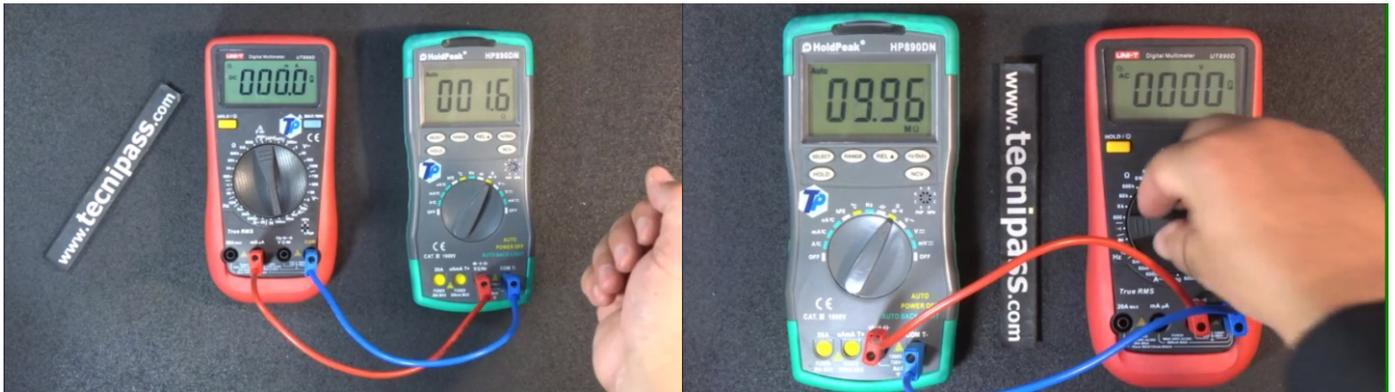
**Mesurez les impédances en calibre voltmètre et ampèremètre :**
